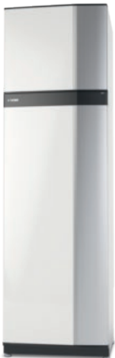
Technikpaket 3A Abluftwärmepumpe mit integriertem 180-Liter-Warmwasserspeicher und Wärmerückgewinnung durch Abluftmodul in der Wärmepumpe integriert (Zuluft dezentral, Abluft zentral)
